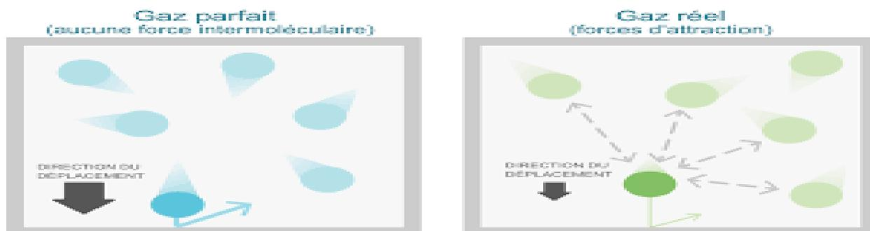
A la différence avec un gaz réel (à droite), un gaz parfait (à gauche) n'observe aucune interaction entre les molécules le constituant.
