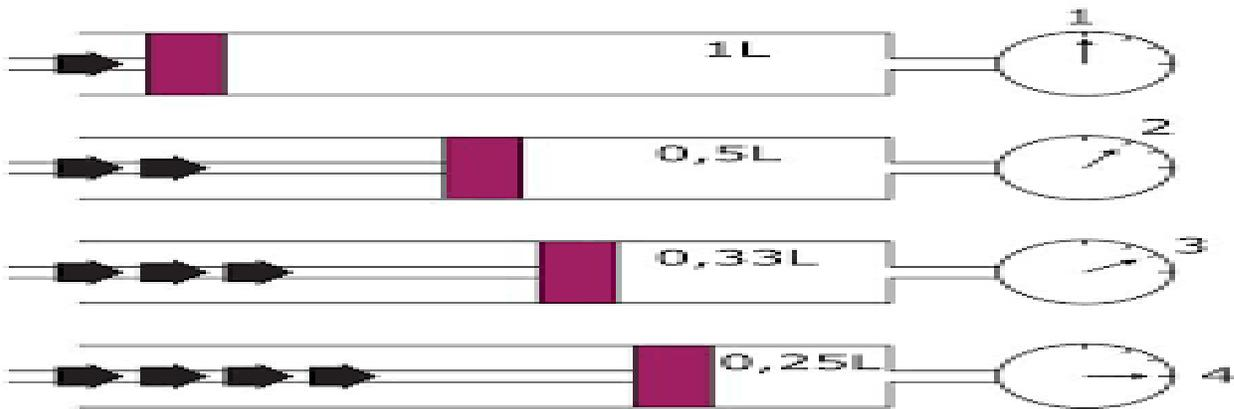
Ainsi que le décrit la loi de Boyle-Mariotte, lorsque la pression sur le piston est augmentée, le gaz est comprimé, et le volume est divisé.
